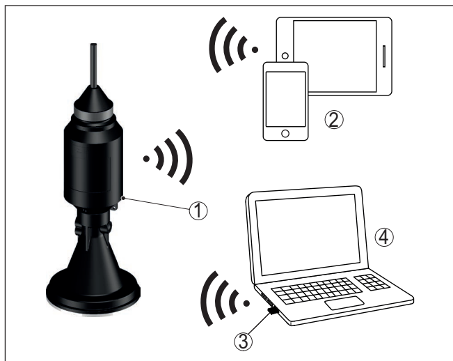
Рис. 4: Беспроводное соединение со стандартными устройствами для настройки
