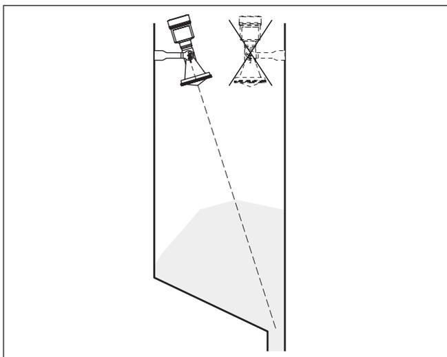
Рис. 21: Монтаж и ориентация датчика в многокамерном силосе
