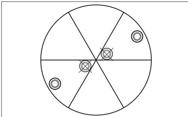
Рис. 20: Монтаж и ориентация датчика в многокамерном силосе
