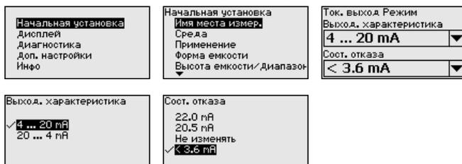
Заводская установка: выходная характеристика 4 ... 20 mA, состояние отказа < 3,6 mA.
