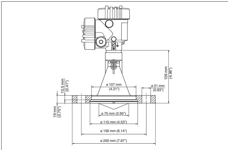
Рис. 50: VEGAPULS 67, накидной фланец для DN 80 PN 16/ASME 3" 150lbs/JIS80 10K
