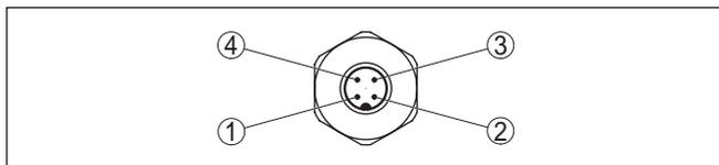
Рис. 28: Вид штекерного разъема M12 x 1
