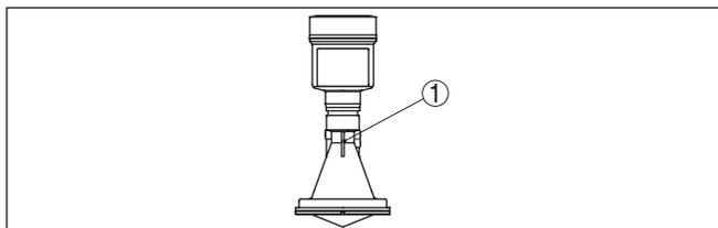
Рис. 6: Положение поляризации
