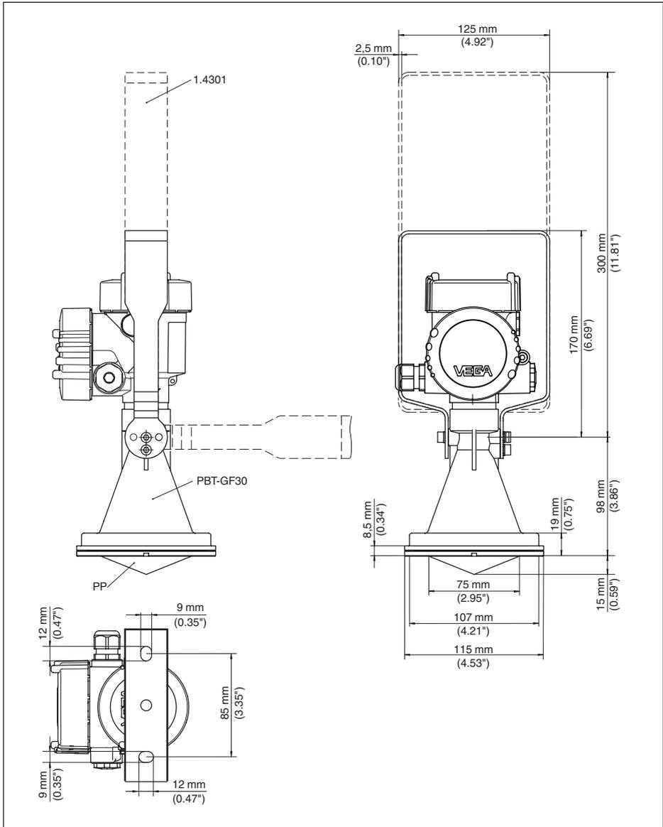
Рис. 49: VEGAPULS 67, с монтажной скобой
