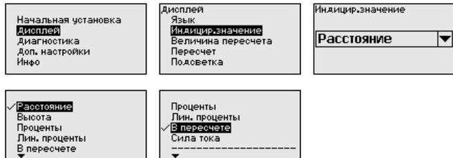
Заводская установка индицируемого значения для радарных датчиков: Расстояние.
