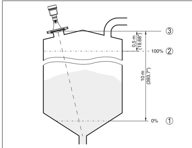
Рис. 32: Пример выполнения Установки Min./Max.
