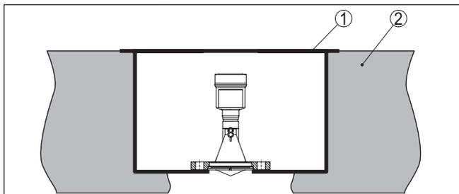
Рис. 19: Монтаж прибора в коробе под полом
