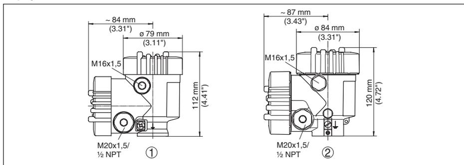
Рис. 48: Размеры корпуса - с установленным модулем индикации и настройки корпус выше на 9 мм (0.35 in)
