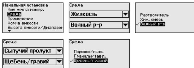
Данная установка позволяет повысить надежность измерения, особенно на средах со слабыми отражательными свойствами.
