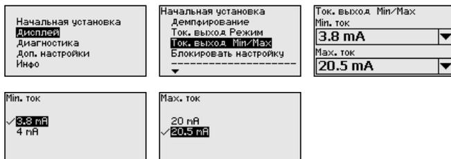
Заводская установка: Min.-ток 3,8 mA и Max.-ток 20,5 mA.
