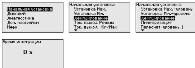
Заводская установка времени интеграции: 0 s или 1 s (в зависимости от типа датчика).
