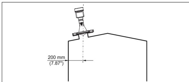
Рис. 7: Монтаж радарного датчика на крыше емкости
