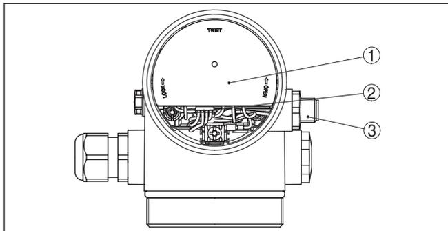
Рис. 27: Вид отсека электроники с DISADAPT для подключения выносного устройства индикации и настройки
