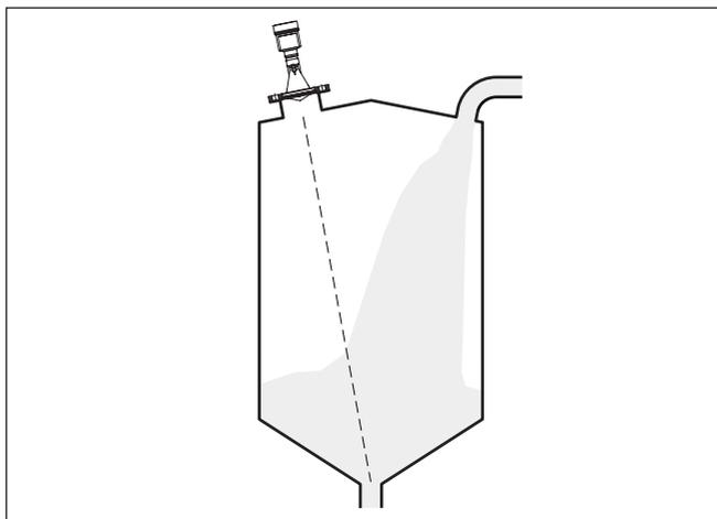
Рис. 8: Монтаж радарного датчика при втекающем продукте, при заполнении сверху
