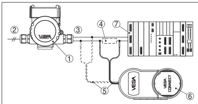
Рис. 34: Подключение ПК к сигнальному кабелю через HART
