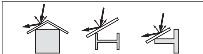
Рис. 17: Отражатели над конструкциями в емкости
