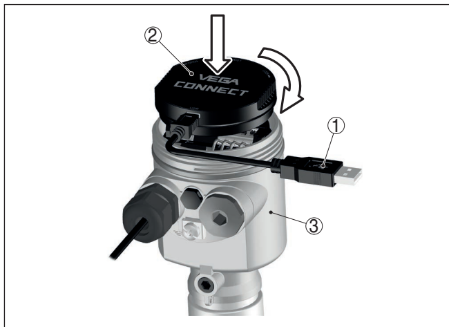
Рис. 25: Подключение ПК через интерфейсный адаптер прямо к датчику
