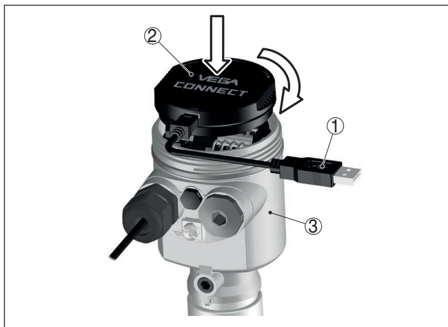
Рис. 18: Подключение ПК через интерфейсный адаптер прямо к датчику
