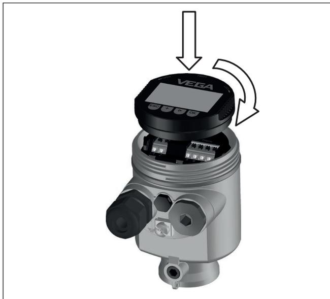
Рис. 28: Установка модуля индикации и настройки в отсеке электроники однокамерного корпуса
