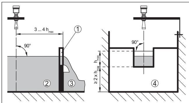
Рис. 21: Измерение расхода с прямоугольным водосливом:  $d_{min}$  = минимальное расстояние датчика (см. гл. "Технические данные");  $h_{max}$  =  $h_{min}$  / 2, заполнение прямоугольного водослива
