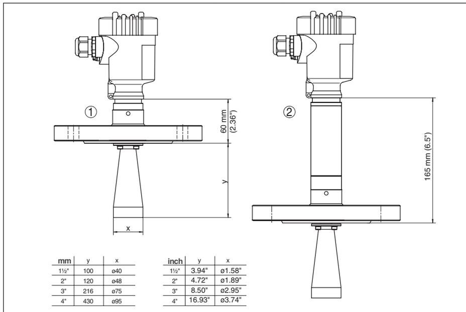
Рис. 69: VEGAPULS 62, с рупорной антенной и фланцевым присоединением
