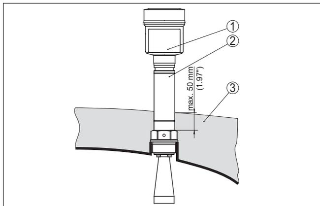
Рис. 17: Монтаж устройства на емкости с термоизоляцией
