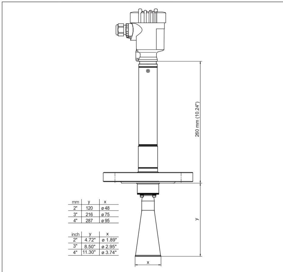
Рис. 71: VEGAPULS 62, с рупорной антенной и фланцевым присоединением, с температурной вставкой до 450 °С
