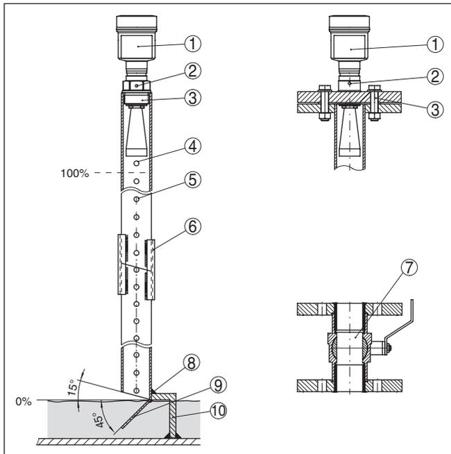
Рис. 18: Монтаж VEGAPULS 62 в уравнильной трубе
