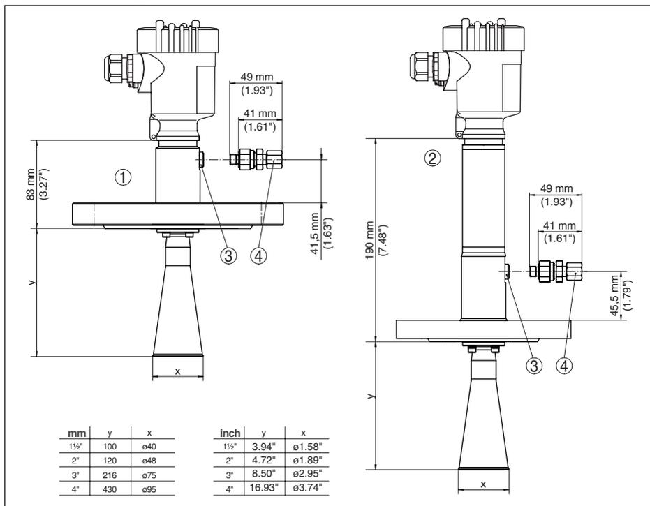
Рис. 70: VEGAPULS 62, с рупорной антенной и фланцевым присоединением, со входом для подключения продувки
