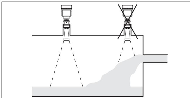
Рис. 7: Монтаж радарного датчика при втекающем продукте
