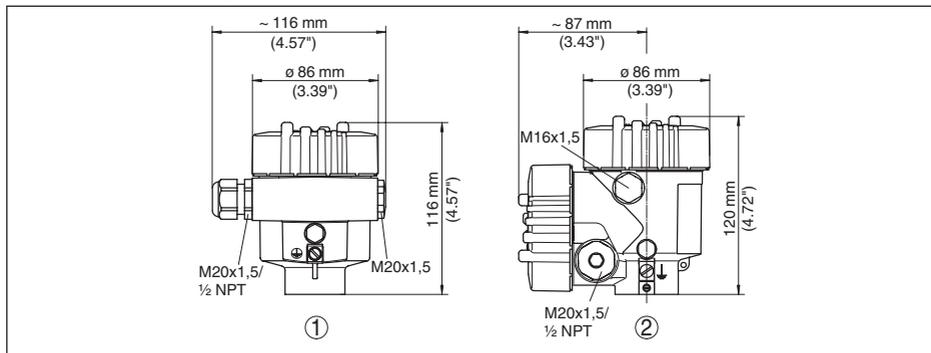
Рис. 64: Корпуса в исполнении IP 66/IP 68 (0,2 bar) - с установленным модулем индикации и настройки корпус выше на 9 mm/0.35 in
