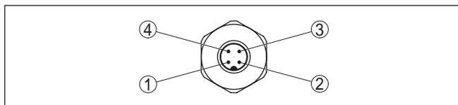
Рис. 33: Вид штекерного разъема M12 x 1
