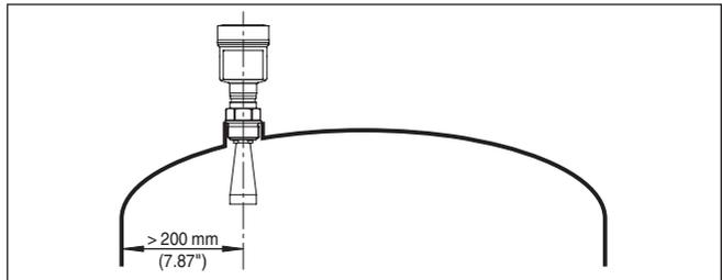
Рис. 5: Монтаж радарного датчика на округлой крыше емкости
