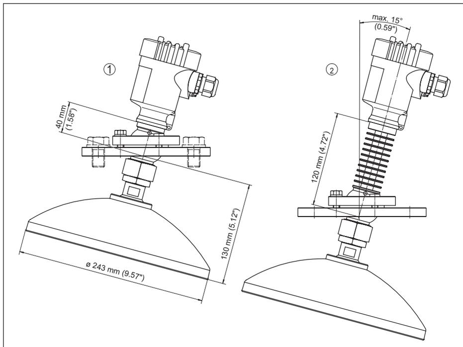
Рис. 74: VEGAPULS 62, с параболической антенной и поворотным креплением
