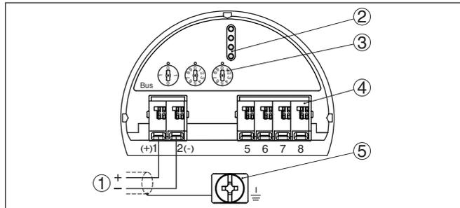
Рис. 25: Отсек электроники и подключения (однокамерный корпус)
