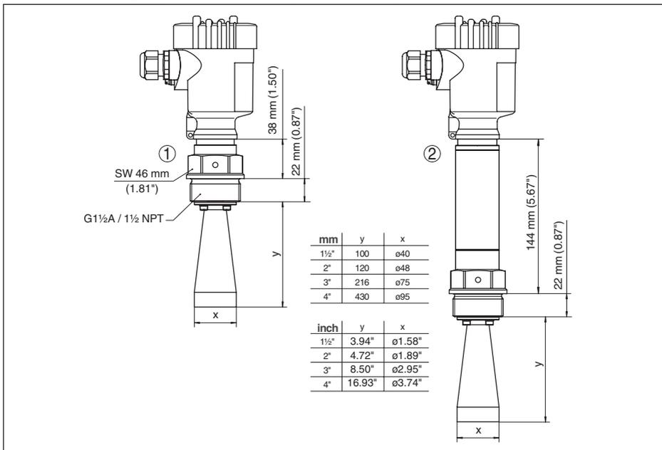
Рис. 68: VEGAPULS 62 с рупорной антенной и резьбовым присоединением
