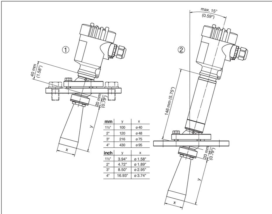
Рис. 72: VEGAPULS 62, с рупорной антенной и поворотным креплением
