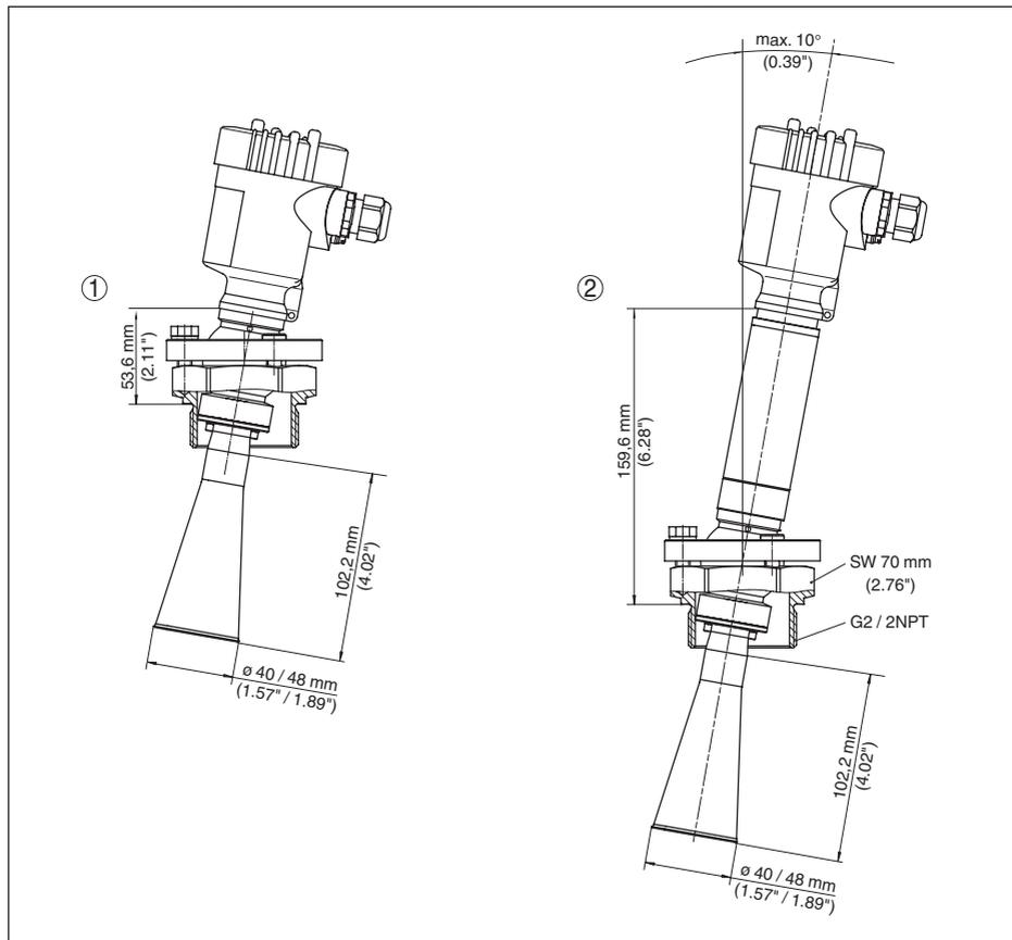
Рис. 73: VEGAPULS 62, рупорная антенна и поворотный держатель, резьбовое присоединение
