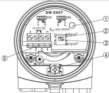
Отсек электроники и подключения (однокамерный корпус)
