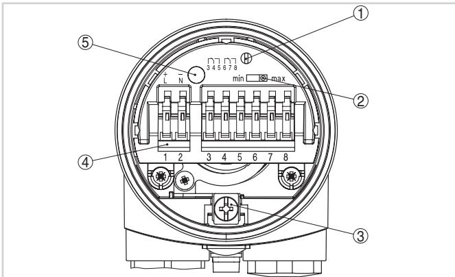
Отсек электроники и подключения - релейный выход
