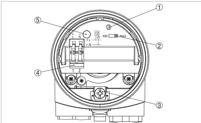
Отсек электроники и подключения - бесконтактный переключатель
