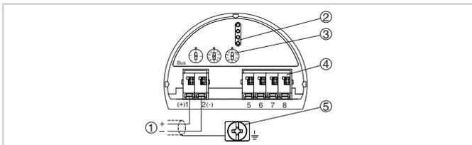
Отсек электроники и подключения (однокамерный корпус)
