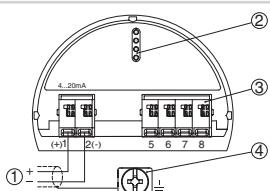
Отсек электроники и подключения (однокамерный корпус)
