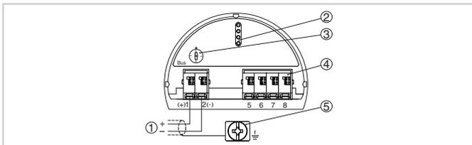
Отсек электроники и подключения (однокамерный корпус)
