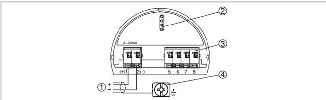
Отсек электроники и подключения (однокамерный корпус)
