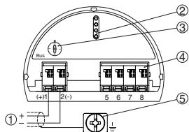
Отсек электроники и подключения (однокамерный корпус)
