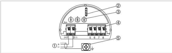
Отсек электроники и подключения (однокамерный корпус)
