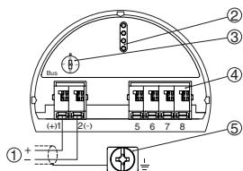
Отсек электроники и подключения (однокамерный корпус)
