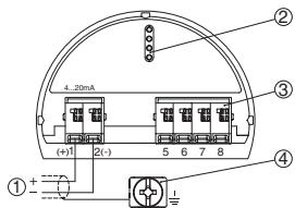
Отсек электроники и подключения (однокамерный корпус)
