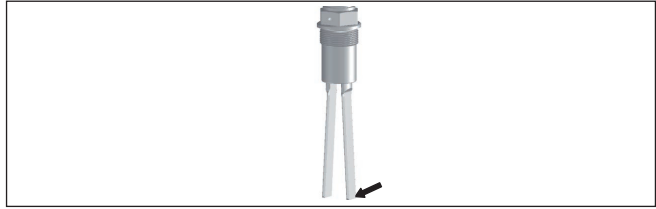
Рис. 31: Максимальная боковая нагрузка вдоль стороны вилки (к узкой стороне вилки)
