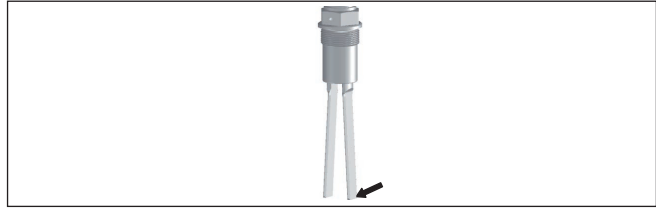
Рис. 26: Максимальная боковая нагрузка вдоль стороны вилки (к узкой стороне вилки)
