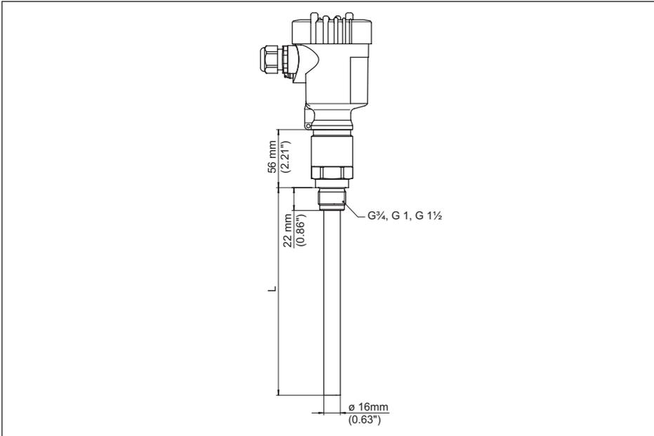
Рис. 30: VEGACAP 63, Резьбовое исполнение G1 (ISO 228 T1)
