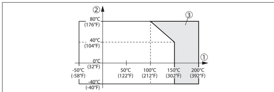
Рис. 27: Температура окружающей среды - Температура процесса
