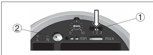
Рис. 26: Переключатель компенсации
