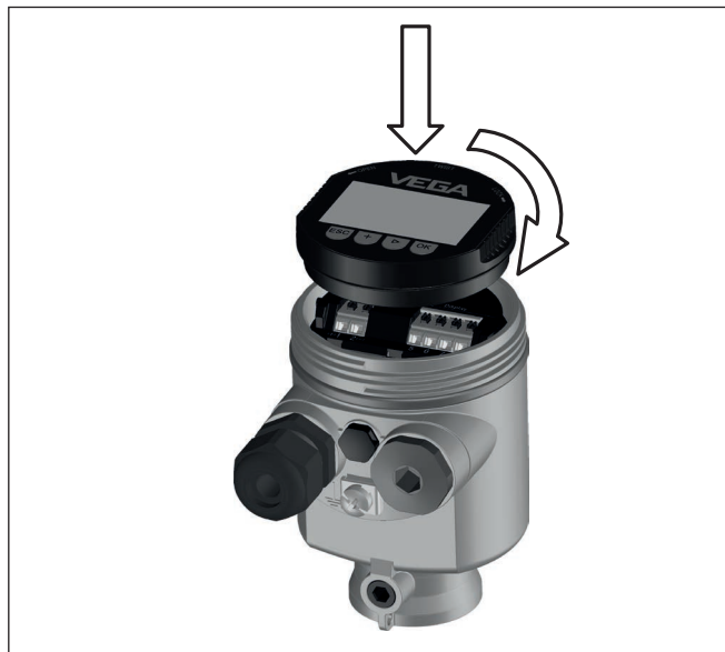
Рис. 33: Установка модуля индикации и настройки в отсеке электроники однокамерного корпуса
