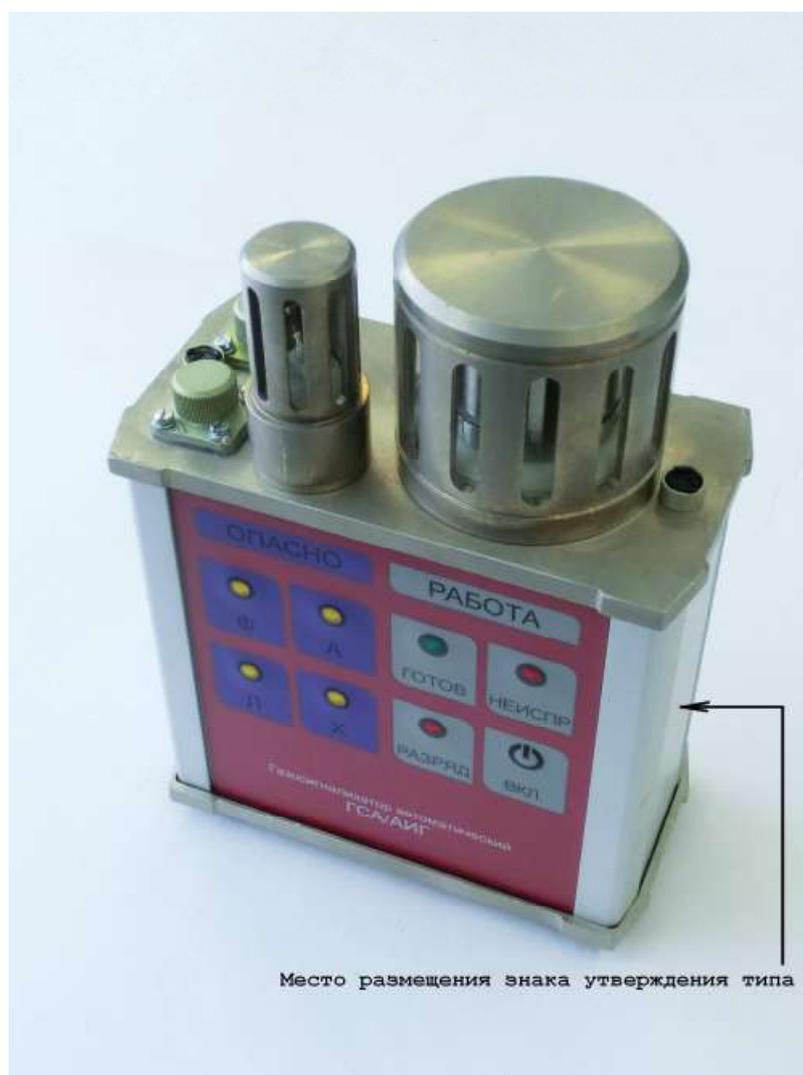
Рисунок 1 - Общий вид газосигнализатора автоматического ГСА/АИГ
