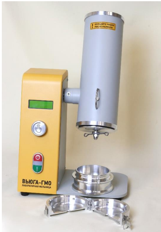
Рис. 3. Положение размольного узла при загрузке и выгрузке проб
