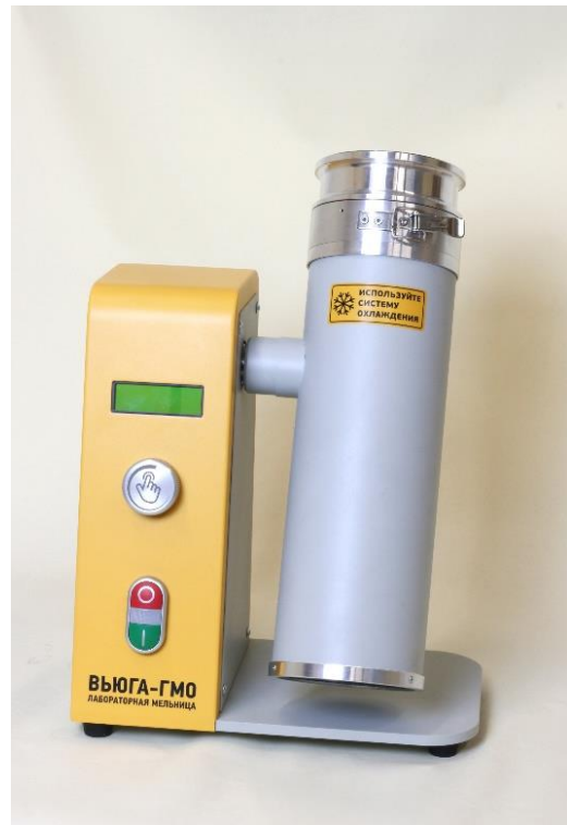
Рис. 4. Положение размольного узла при размоле проб (рабочее положение)
