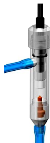
Рис. 3.7. Фиксация АСрН 2 в измерительной камере.
