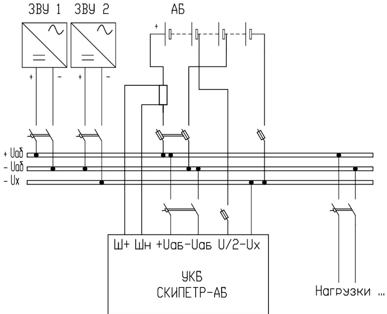
Рис.2. Типовая схема подключения УКБ в СОПТ.
