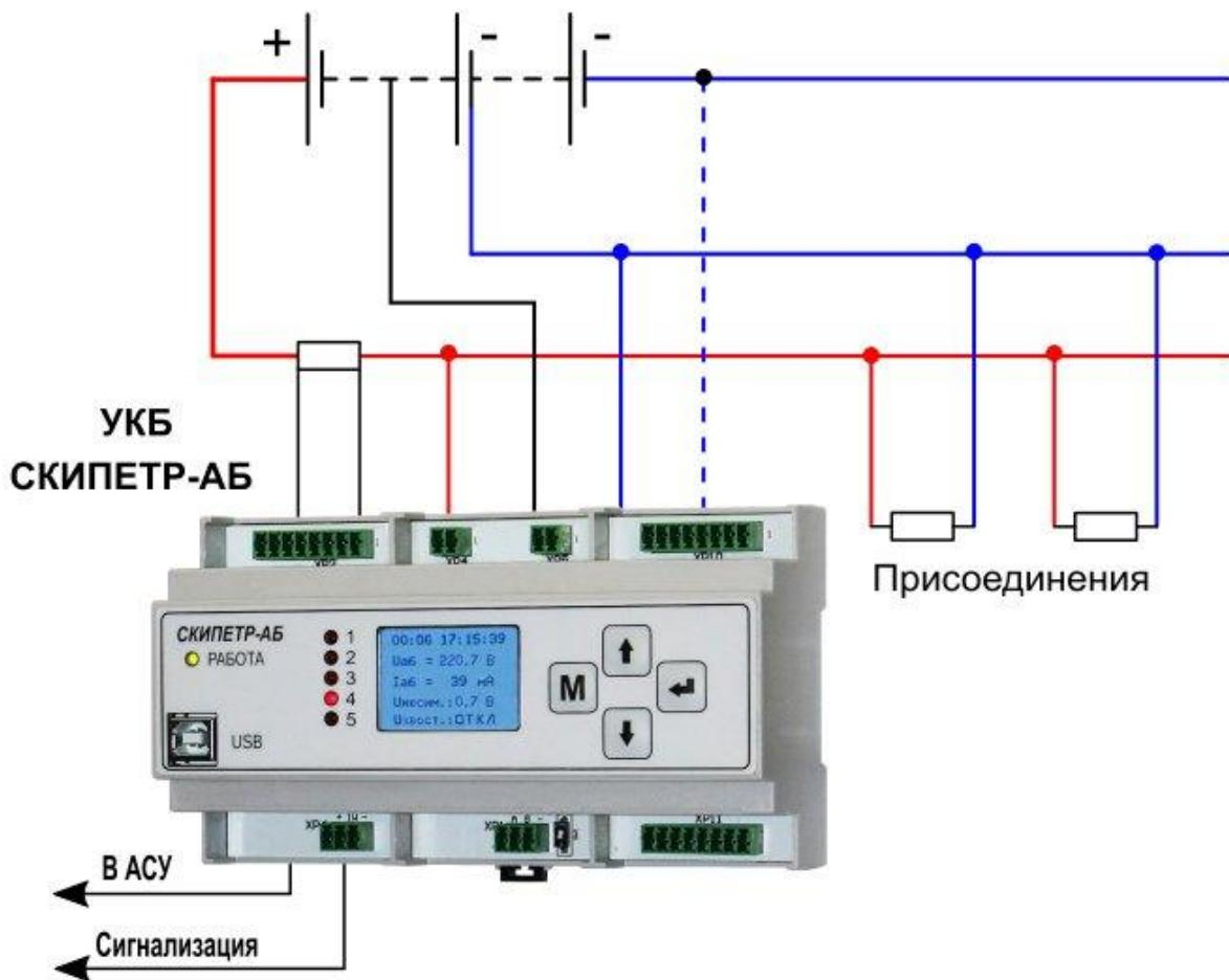
Для контроля тока заряда-разряда АБ и пульсаций зарядного тока применяется стандартный шунт с номинальным выходным измерительным напряжением 75 мВ.
