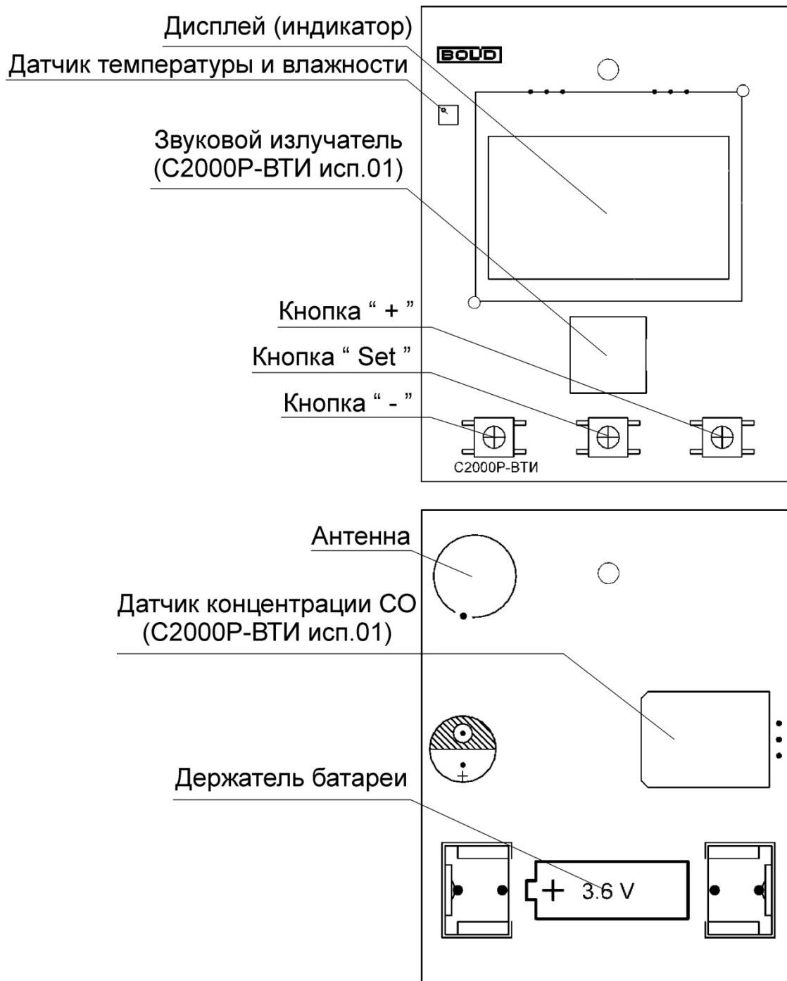
Рисунок 2.3 Расположение элементов на плате
