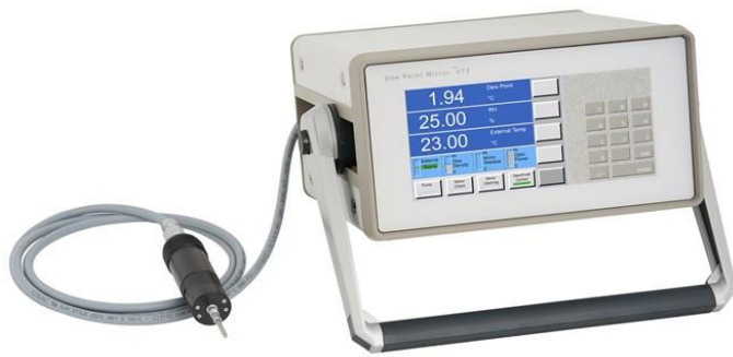
Рисунок 2 - Внешний вид контрольных конденсационных гигрометров 473-RP2 Dew Point Mirror (слева) и Michell Instruments S8000 Remote (справа), входящих в состав генераторов модификаций Humiwell-473 и Humiwell-S8000
