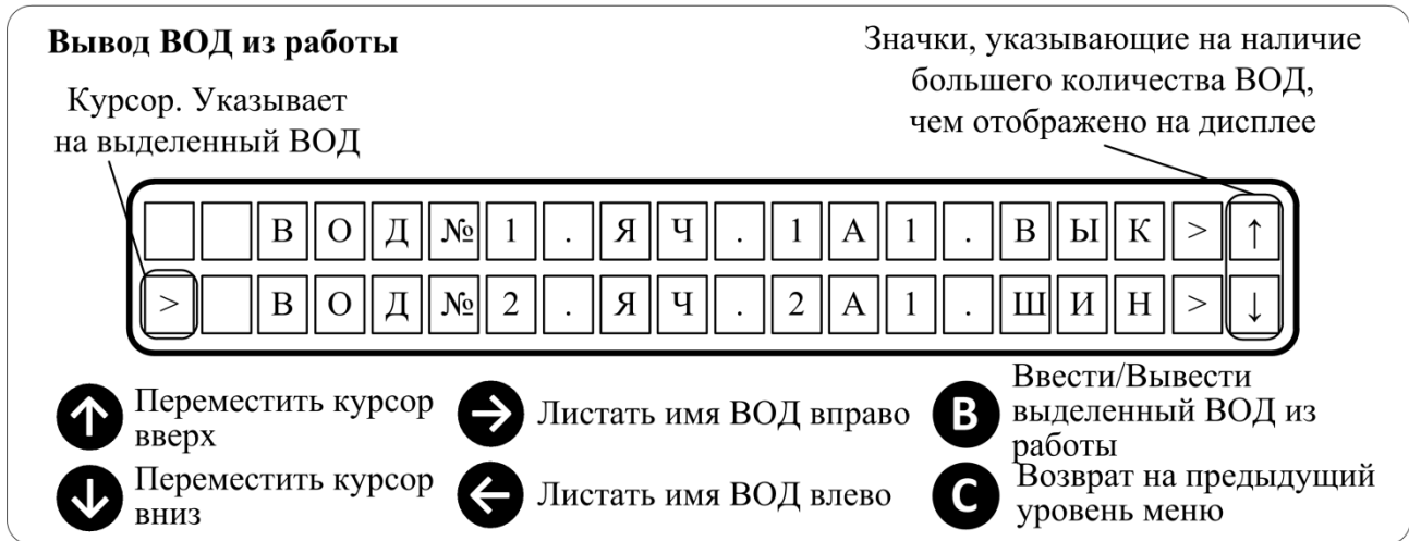
Рисунок 2.18 – Ввод/Вывод датчиков из работы
