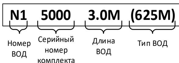
Рисунок 1.9 — Формат маркировки датчика ВОД
