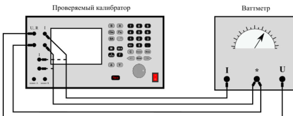
б)- ваттметры с общим выводом
