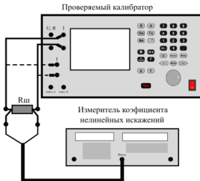
Рисунок 13.15 – Измерительная схема для определения коэффициента нелинейных искажений в режиме воспроизведения силы переменного тока
