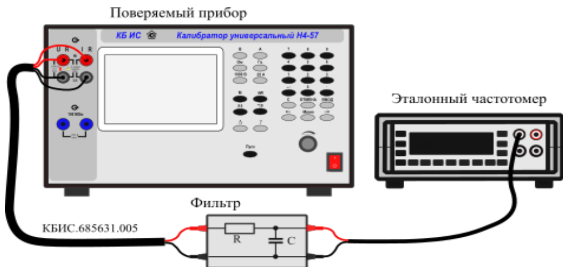
Рисунок 13.14 – Схема измерения для определения погрешности воспроизведения частоты
