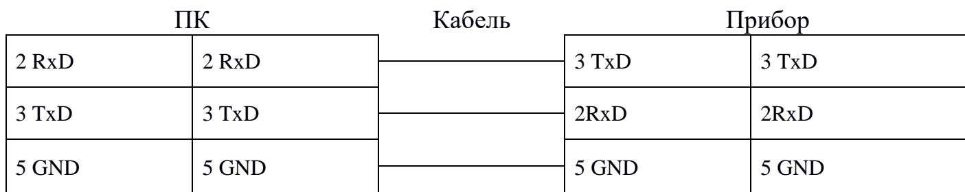
Рисунок 9.26 - Соединение по интерфейсу RS-232
