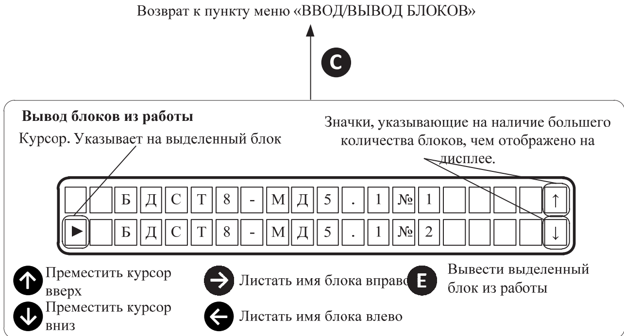
Рис. 2.12 Вывод блоков устройства из работы.
