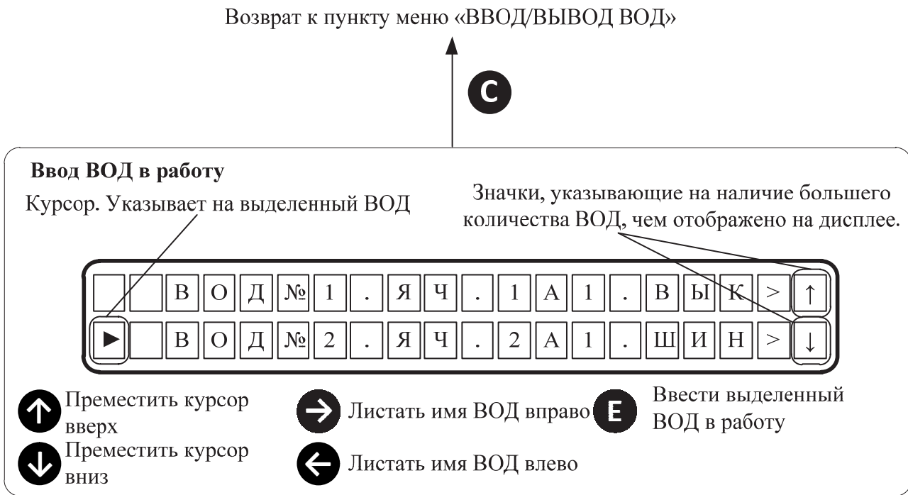
Рис. 2.11 Ввод ВОД в работу.
