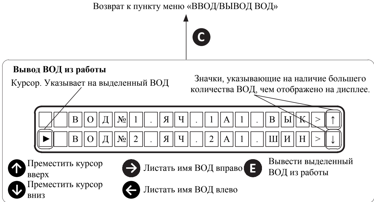
Рис. 2.10 Вывод ВОД из работы.
