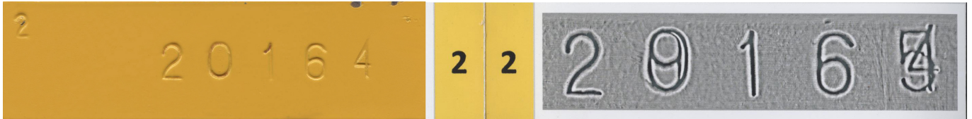
Заливка оловом (пайка) знаков
