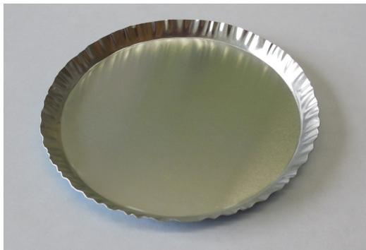
Тарелочки многоразового использования, но так как высохший лак трудно убрать с поверхности тарелочки (а выкидывать тарелочку после одного измерения нерационально и расточительно), предлагаем в тарелочку класть вкладыш из фольги. В результате проведённых экспериментов рекомендуем следующую технологию изготовления одноразовых вкладышей:
