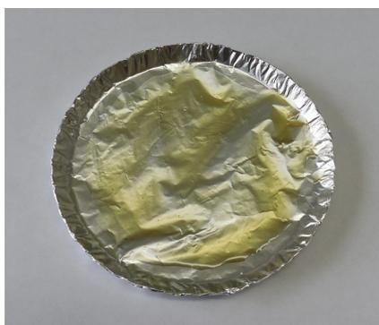
8) Берём пинцетом тарелочку с вкладышем и пробой лака и кладём на крестовину анализатора.
