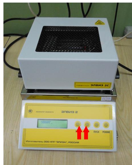
4) Нажатием на кнопку «ТАР» обнуляем вес тарелочки с вкладышем (**таруем**);
