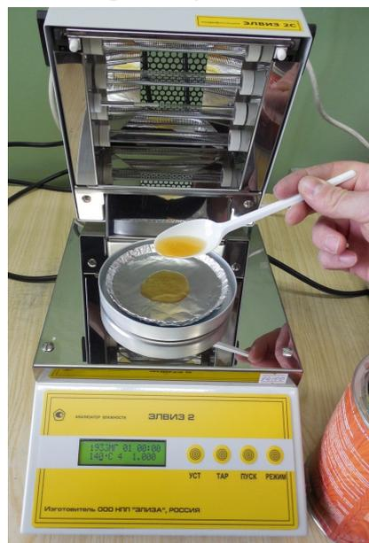
7) Снимаем тарелочку с вкладышем с крестовины, кладём на ровную поверхность и аккуратно распределяем лак ложечкой по поверхности вкладыша. **Ни в коем случае нельзя разравнивать лак в тарелочке находящейся на крестовине прибора!** Весы в анализаторе очень чувствительно и прикладывая к ним не предусмотренные усилия можно их сломать.
