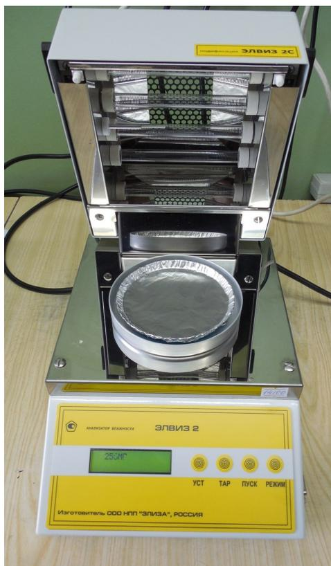
3) На крестовину пробоприёмника ставим тарелочку с вкладышем.
