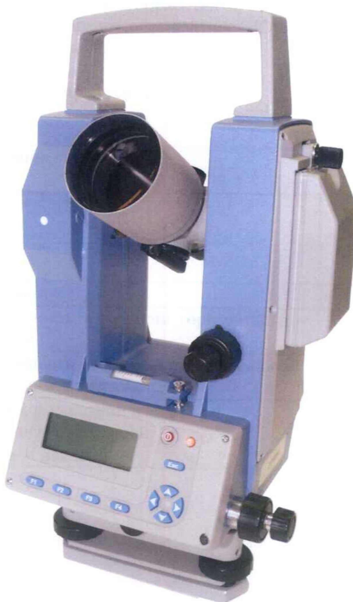
Рисунок 2 – Фотография внешнего вида электронного теодолита 2Т5ЭН1
