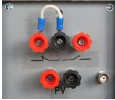
Рис.№3 Вид панели клемм вспомогательных контактов прибора УПЗ-450/3000.
