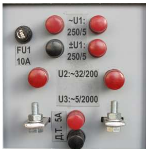
Рис.№4 Вид панели силовых клемм прибора УПЗ-450/3000.
