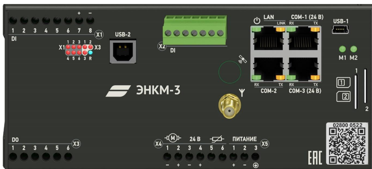
Рисунок 3.10. Лицевая панель ЭНКМ-3-24-A3E1-1242
