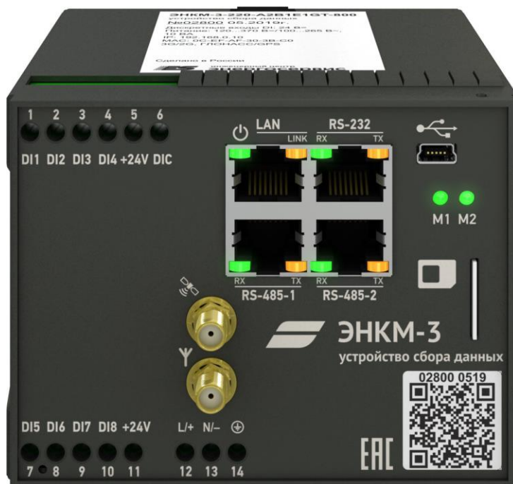
Рисунок 1.3. Внешний вид ЭНКМ-3-220-A2B1E1GT-800
