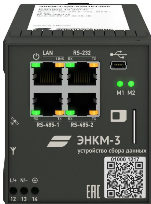
Рисунок 1.1. Внешний вид ЭНКМ-3-220-A2B1E1-000
