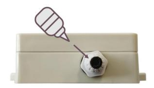
4. Нанесите силиконовый клей-герметик по периметру уплотняющей резинки гермоввода.
