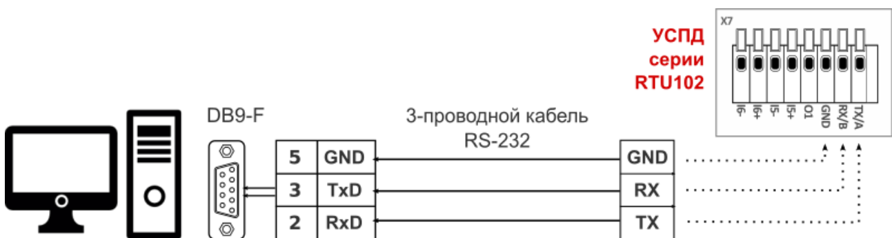
Рис. 48. Подключение УСПД серии RTU102 к ПК по интерфейсу RS-232.
