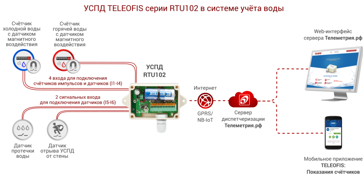
Рис. 12. УСПД RTU102 в системе учёта воды.
