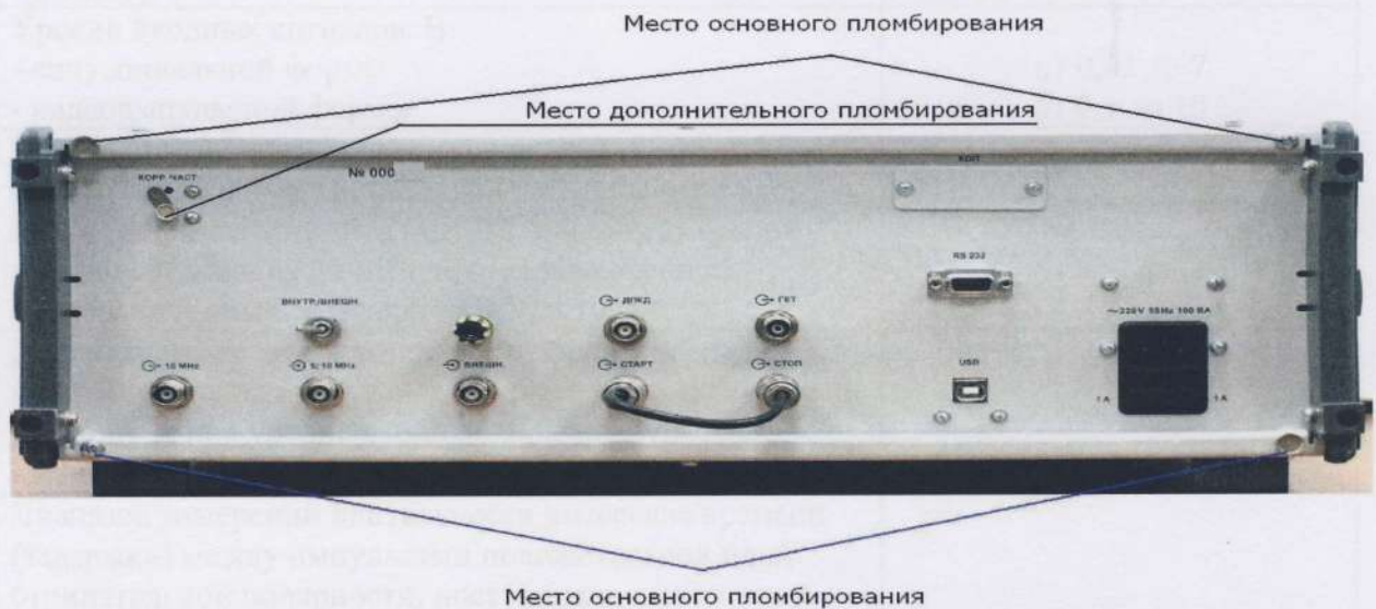
Рисунок 2 - Схема пломбировки от несанкционированного доступа
