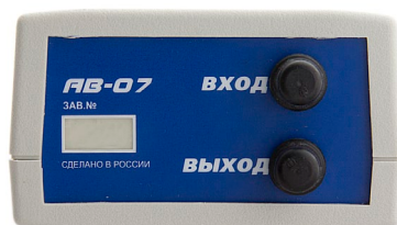
Рисунок 7б. Задняя панель управления автономной воздуходувкой АВ-07
