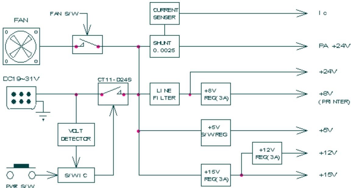
Цель питания состоит из цепи управления питанием 24В постоянного тока в усилителе мощности, на каждый элемент подаётся постоянное напряжение; аудио усилитель для внешнего громкоговорителя работает от батареи, при подаче постоянного тока 24В.
