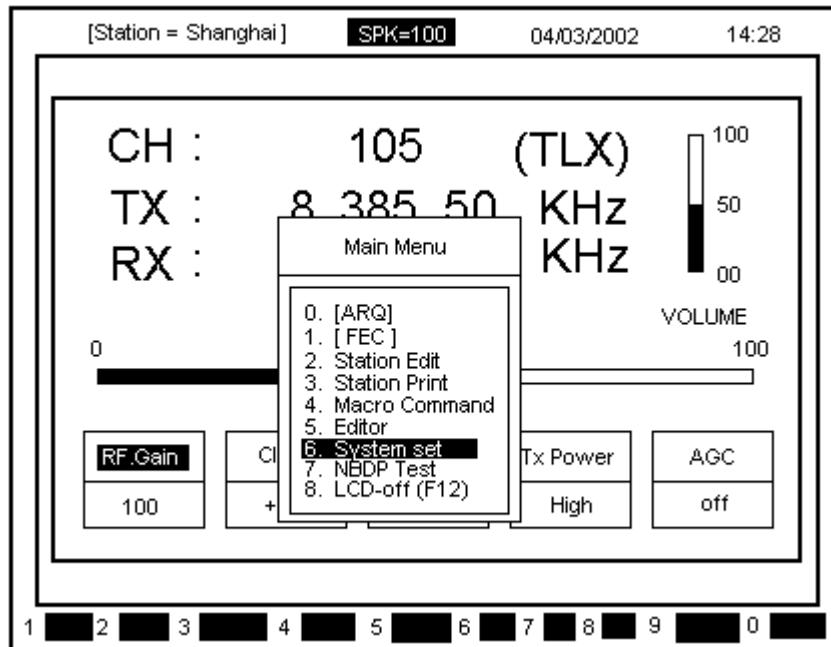
б) при помощи кнопок [ $\blacktriangle$ ],[ $\blacktriangledown$ ] выделите пункт [System Set] и нажмите кнопку [ENT]. На экране появится следующее изображение:
