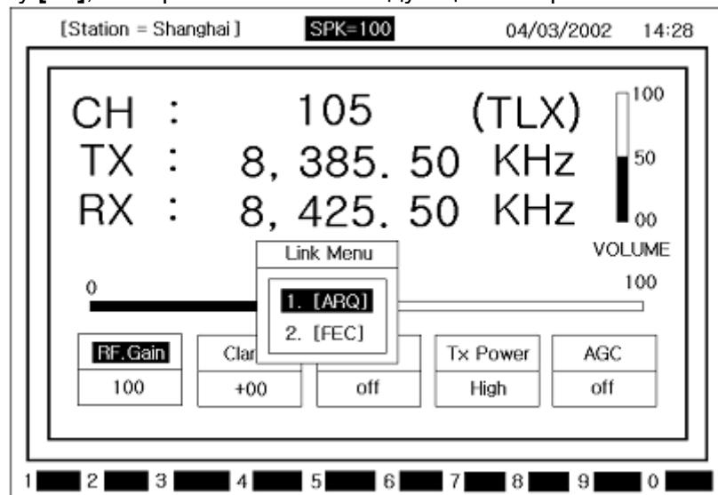
б) При помощи кнопок [ $\blacktriangle$ ],[ $\blacktriangledown$ ] выделите пункт [ARQ] и нажмите кнопку [ENT].
