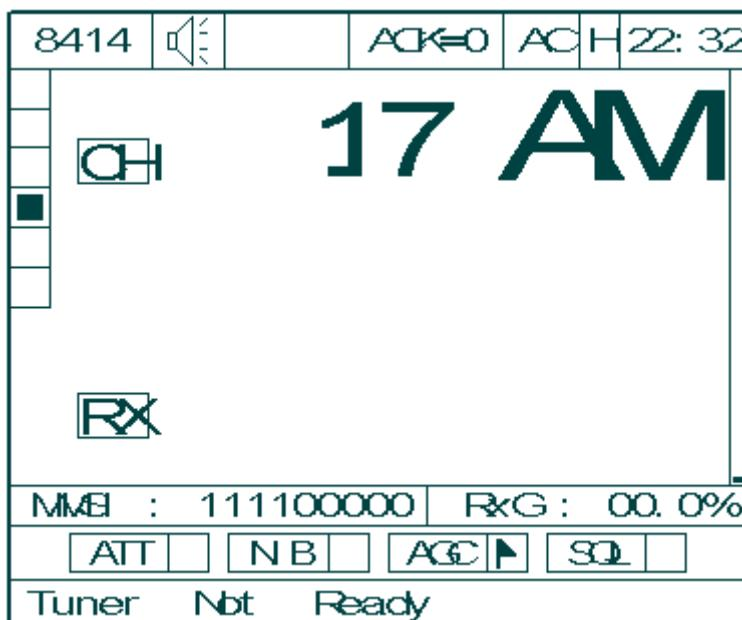
\* В режиме АМ передача не отображается (отображается только прием). Режим AGC постоянно находится в положении ON.
