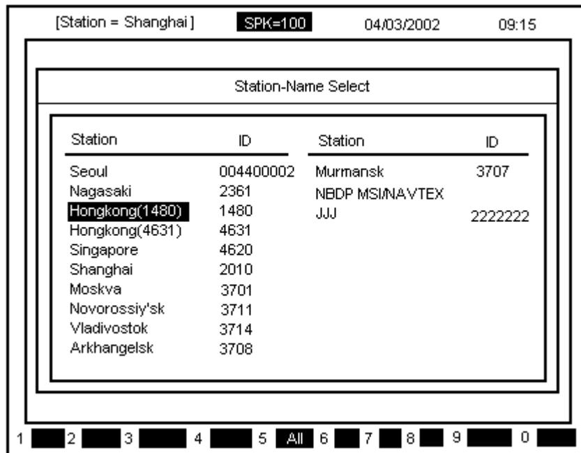
в) При помощи кнопок [**▲▼**] выделите желаемую станцию и нажмите кнопку **[ENT]**, на принтер будут выведены частоты выделенной станции.
