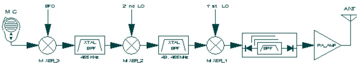
С микрофона (MIC) или NBDRP терминала SN-100 поступает сигнал BASE BAND. MIXER 3,2 (T-474 IC1,MX2) смешивается с сигналом BFO и частотой 2'nd LOCAL.
