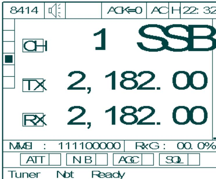
1) Как показано ниже, при нажатии кнопки SSB, происходит переход на экран AM. Если еще раз нажать SSB, экран возвращается в исходное положение.
