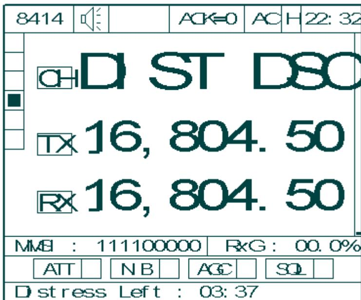
в) Для остановки передачи нажмите кнопку [STOP]. Остановка передачи канала произойдет только тогда, когда завершится передача.
