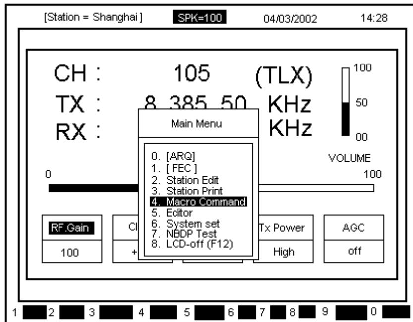
б) При помощи кнопок [▲],[▼] переместите выделите пункт [Macro Command], и нажмите кнопку [ENT]. На экране появится следующее изображение:
