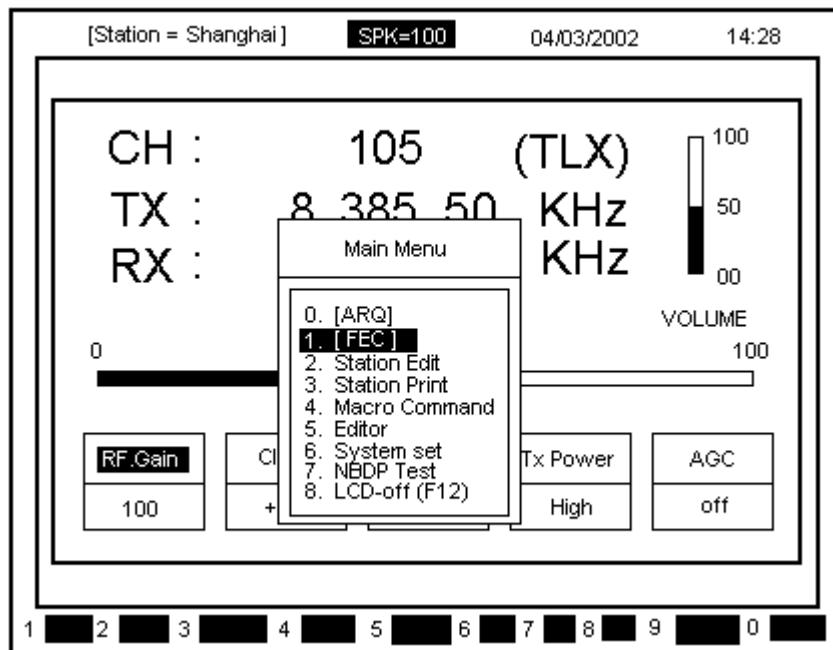
б) При помощи кнопок **[▲],[▼]** выделите пункт **[FEC]** и нажмите кнопку **[ENT]**.
