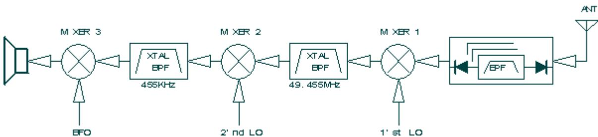
Прием сигнала первой промежуточной частоты IF=49.455МГц, второй - IF=455КГц (Double Super Heterodyne).
