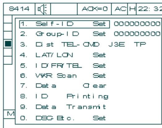
После ввода желаемого ID 111100000 нажать ENT. При нажатии ESC экран возвращается в режим меню.
