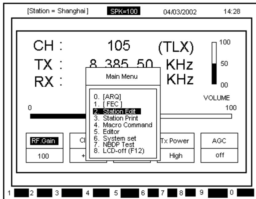
б) При помощи кнопок [▲],[▼] выделите пункт [Station Edit] и нажмите кнопку [ENT].
