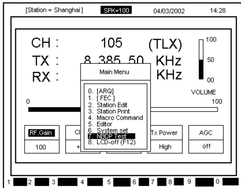
б) при помощи кнопок **[▲],[▼]** выделите пункт **[NBDP Test]** и нажмите кнопку **[ENT]**. На экране появится следующее изображение:
