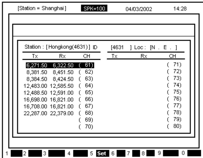
б) При помощи кнопок-стрелок установите курсор на желаемой станции и нажмите кнопку [ENT]. На экране появится следующее изображение :
