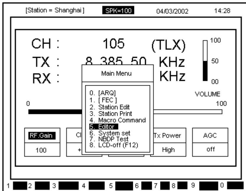
б) При помощи кнопок [▲],[▼] выделите пункт [Editor] и нажмите кнопку [ENT]. На экране появится следующее изображение:
