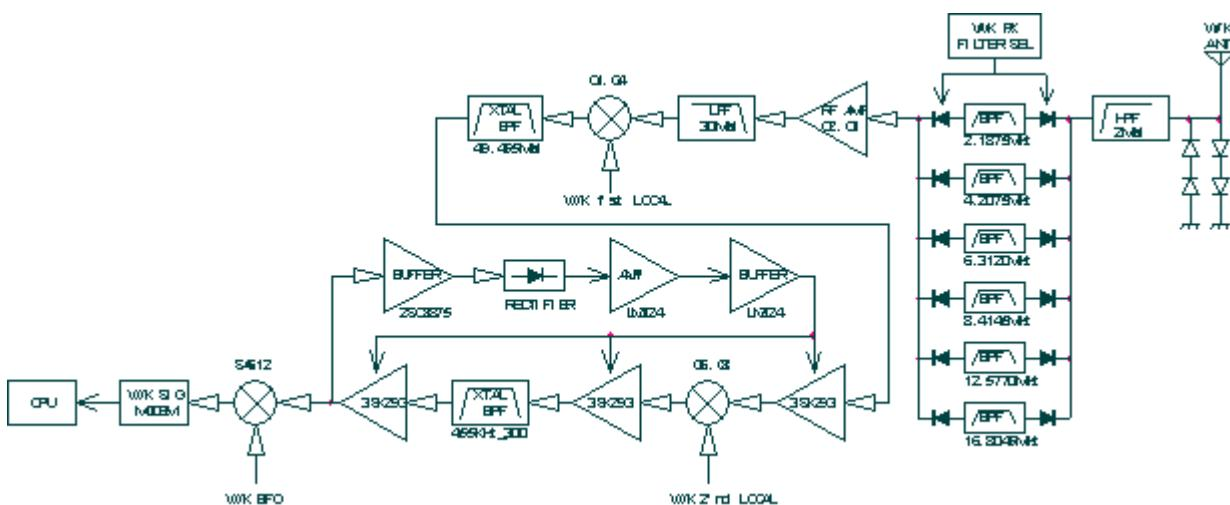
Способ приема - первая промежуточная частота (49.455МГц), двойной супергетеродин (DOUBLE-SUPER HETERODYNE) второй промежуточной частоты (455КГц). Все локальные частоты приемника поступают от дежурного синтезатора (WK Synthesizer) T-1553.
