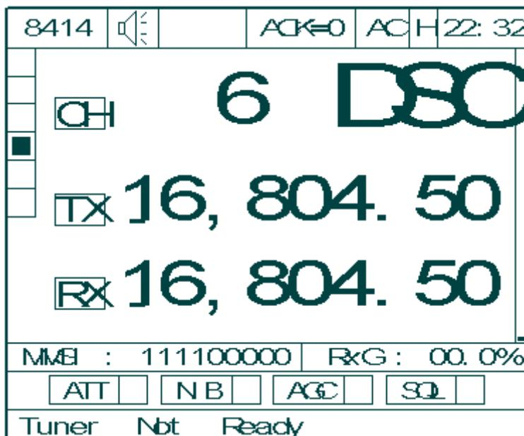
Режим ЦИВ устанавливается нажатием кнопки [DSC] на панели управления.
