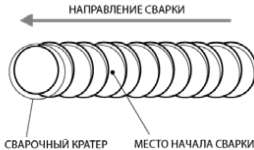
Рис. 11.2.2. Начало сварки при смене электрода.
