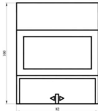
Счетчик устанавливается на DIN-рейку.
