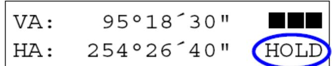
Включает режим суммирования повторных измерений горизонтального угла. (см. стр. 34)
