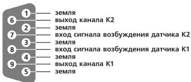
Рисунок 6.2 - Назначение выводов разъема DB-9 (ВЫХОД)
