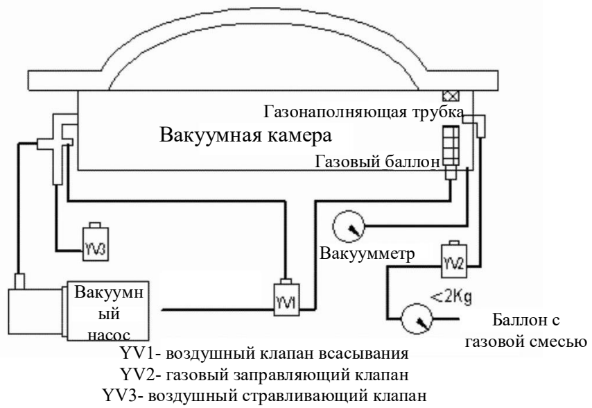
Схема вакуумного упаковщика с системой газации
