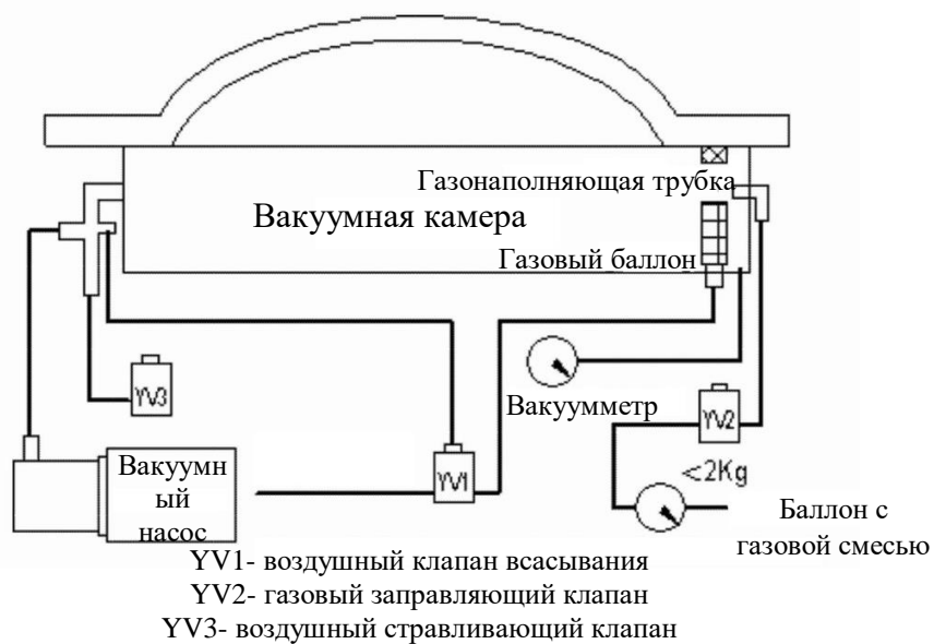
Схема вакуумного упаковщика с системой газации
