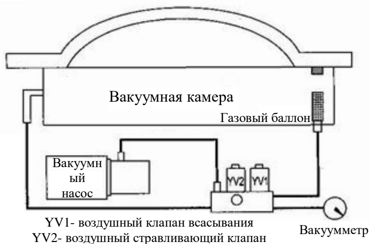
Схема вакуумного упаковщика с производительностью вакуумного насоса более 20 \text{ м}^3
