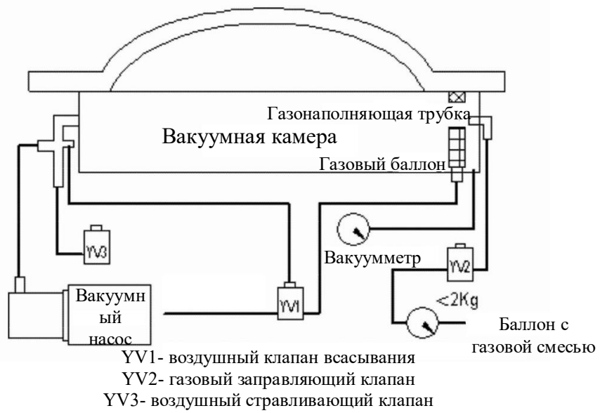
Схема вакуумного упаковщика с системой газации
