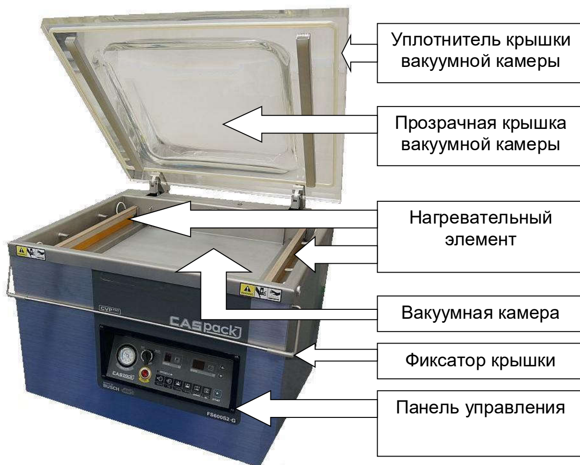
Рисунок 2.1 - Общий вид и обозначение основных элементов
