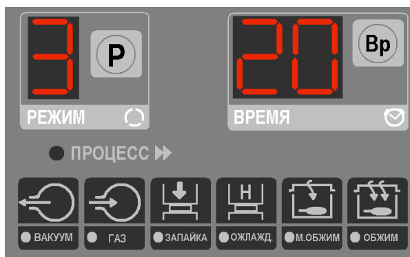
Рисунок 2.3 - Расположение таймера и индикаторов панели управления
